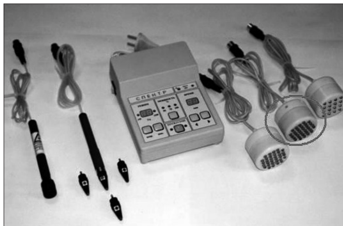
Рис. 1. Аппарат физиотерапевтический Спектр ЛЦ-02. Овалом отмечена матрица зеленых светодиодов, которая использовалась в этой работе.
